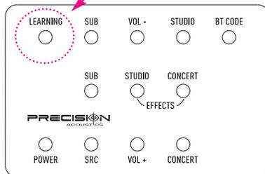
Press the LEARNING button on the sound bar for about three seconds, or until the LED in front of the sound bar starts to flash quickly. / Appuyer sur la touche LEARNING sur la bar de son pour environ trois secondes, ou jusqu'au temps que la lumière commence à clignoter vite.
