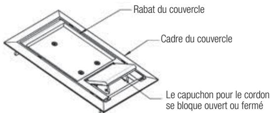
Les couvercles MopTite<sup>MC</sup> sont conformes aux exigences d'étanchéité UL pour l'exclusion des eaux de nettoyage pour les tapis, les carreaux et le bois
