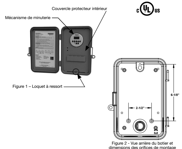
Figure 2 – Vue arrière du boîtier et dimensions des orifices de montage
