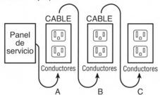
Colocar el interruptor diferencial en la posición A también protegerá a los receptáculos B y C "del lado de la carga". En cambio, colocar el interruptor diferencial en la posición C no brindará protección a los receptáculos A ni B. Recuerde que los receptáculos A, B y C pueden estar en habitaciones distintas.
