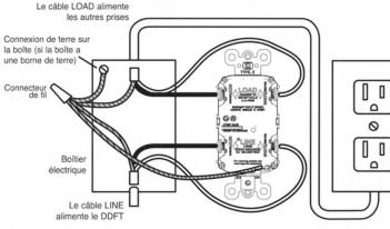
Pour une boîte avec une borne de mise à la terre (schéma ci-dessus) Raccordez un fil de calibre 12 ou 14 AWG en cuivre nu (ou vert) de 15 cm (6 po.) à la borne de terre sur le DDFT. Connectez aussi un fil similaire sur la borne de terre de la boîte. Raccordez les terminaisons de ces fils sur le fil en cuivre nu (ou vert) du câble LINE à l'aide d'un serre-fils. Si ces fils sont déià en place, vérifiez les branchements. Les vis des bornes doivent être serrées à un couple de 14 à 16 in-Lb.
